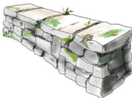
Muret pédagogique en pierres sèches
